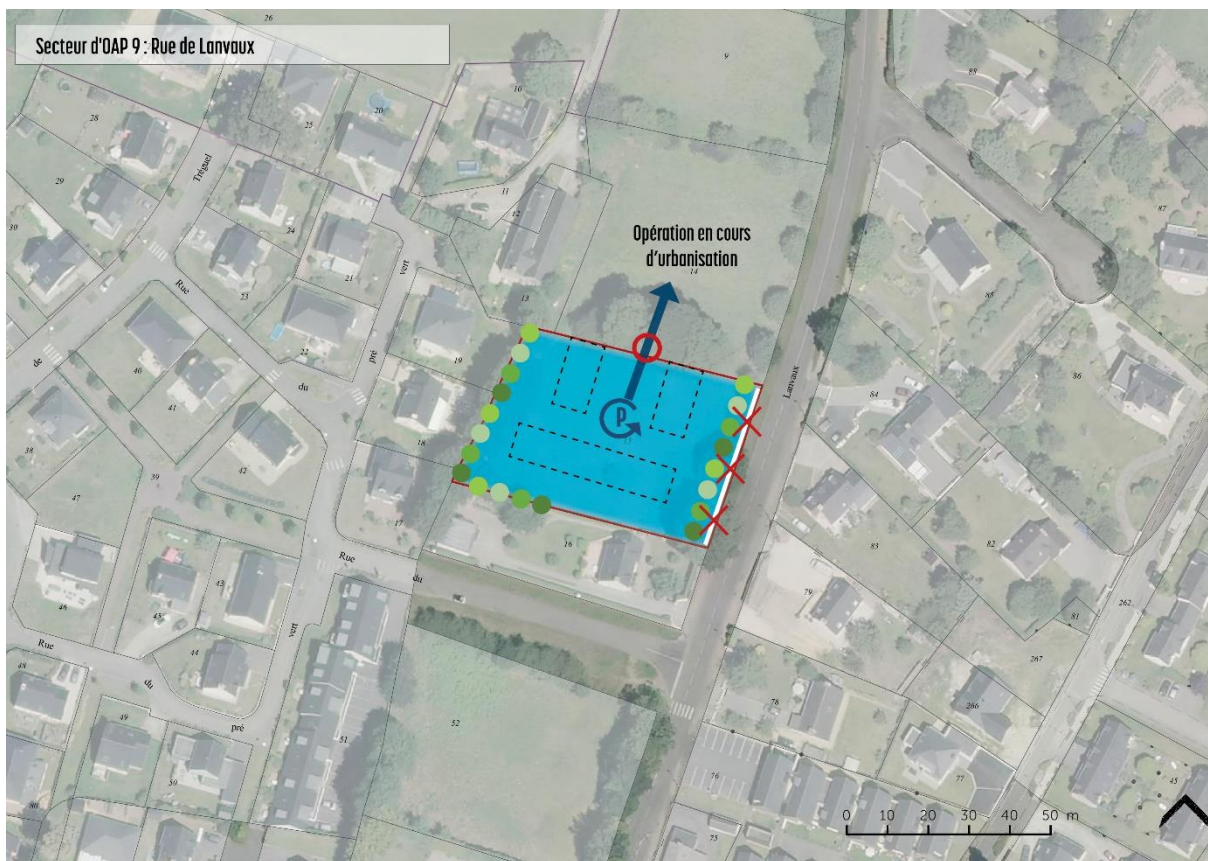
Exemple d'utilisation des principes d'accès sur l'OAP 9, où l'accès est imposé au sein de l'opération afin d'éviter un accès difficile sur la rue de Lanvaux.
