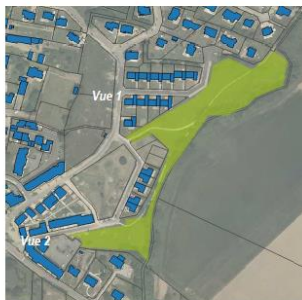
Espace vert du nouveau quartier en limite d'espace naturel intégrant cheminement doux et espaces de rétention d'eaux pluviales
