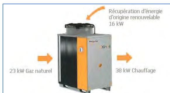
FIGURE 60 : PRINCIPE DE L'AÉROTHERMIE AU GAZ NATUREL
